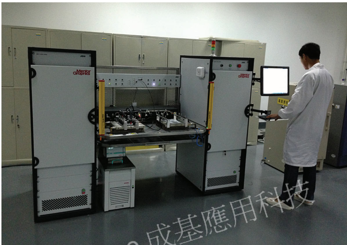
图 8: 中国客户使用 1200A T3Ster 热阻测试系统对 IGBT 器件进行瞬态热测试
